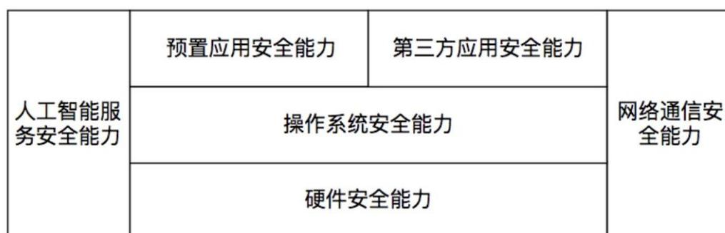
图1 智能电视安全能力架构图
